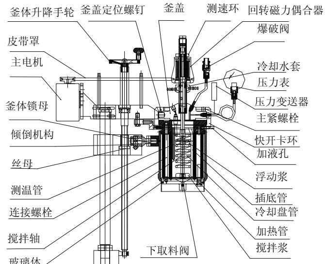
B CFD型反应釜结构示意图3
