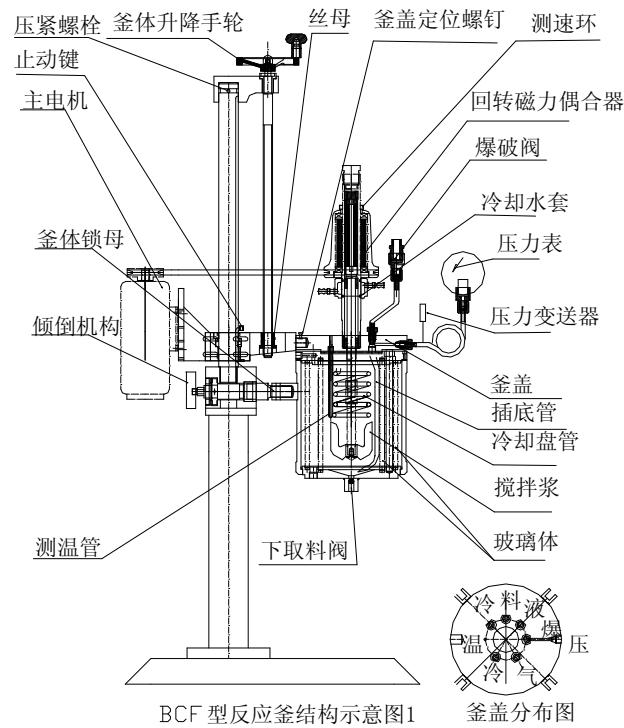
BCF型反应釜结构示意图1
